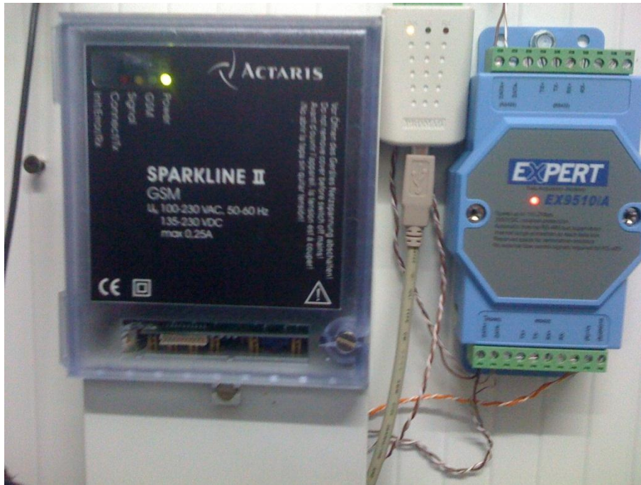
Figura 12. Modem GSM con convertidor RS232/RS485 para lecturas remotas y convertidor USB/RS485 para lecturas con ordenador local.
