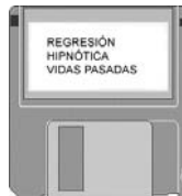
Al escribir, pequeñas áreas del disco se magnetizan en direcciones distintas. Al leer, se detectan los cambios en la dirección de magnetización.
