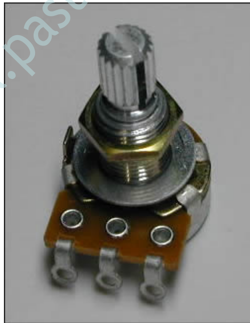
Este es un Potenciómetro Clásico.
