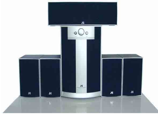
Figura 20.24: Sistema de canales 5.1
