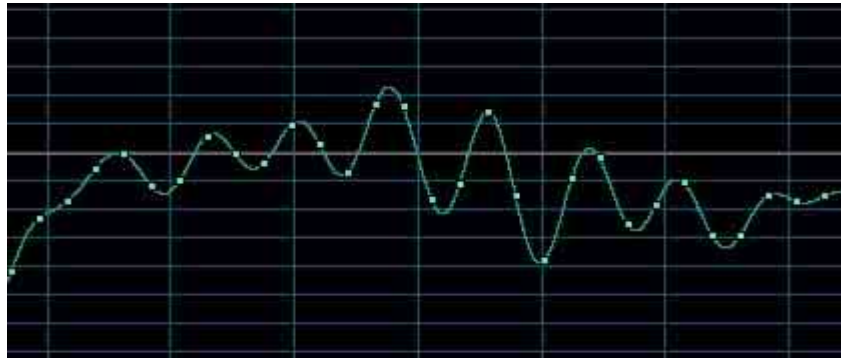
Figura 20.6: Muestreo de una onda sonora continua. Nótese los puntos sobre la onda que recrean la señal.
