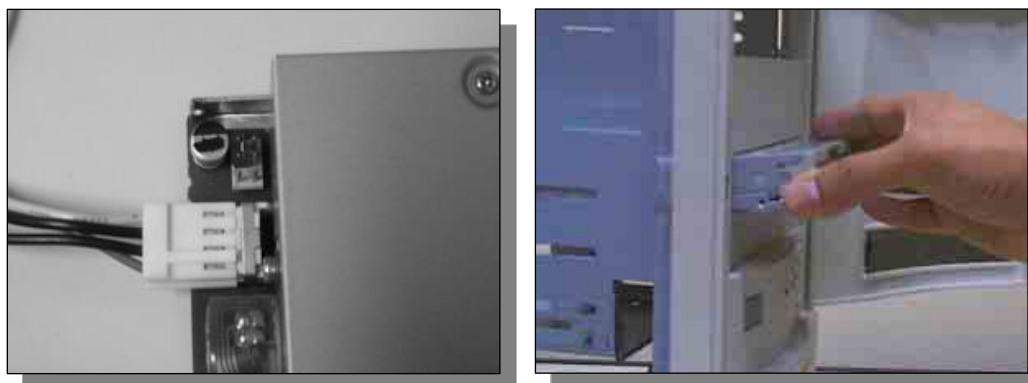
Figura 9.24: Usar al menos 4 tornillos para las disqueteras
