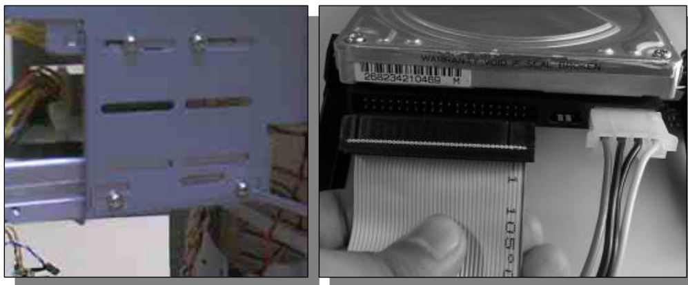
Figura 9.23: Nunca forzar los tornillos de montaje en los discos.
