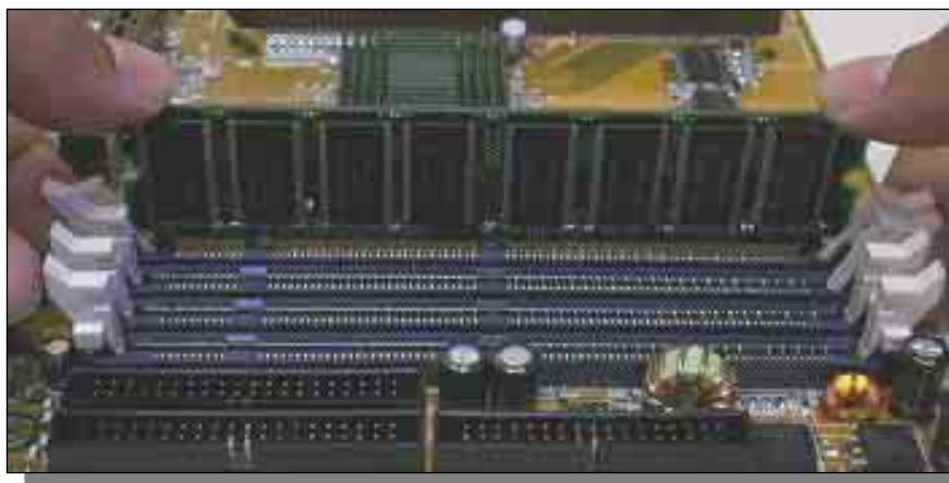
Figura 9.18: Conexión de memoria DIMM
