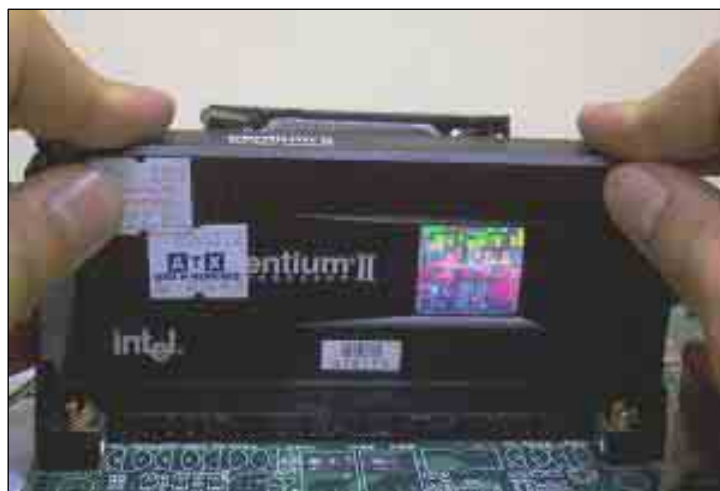
Figura 9.16: Forma correcta de montar un Microprocesador en un SLOT 1
