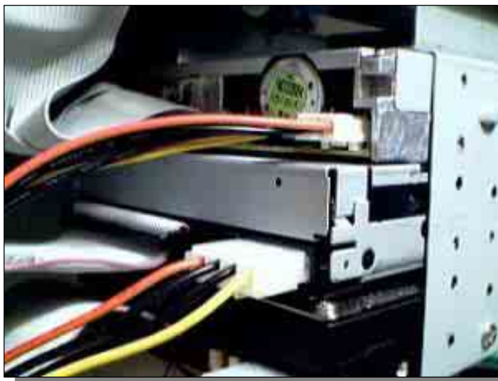
Figura 9.28: Ultimo control. Antes de encender ordenar los cables, controlar conexiones y revisar que no haya nada suelto
