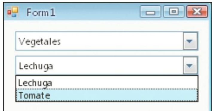
FIGURA 018 | Resultado de la ejecución del código anterior. Al seleccionar una categoría, se llena el combo con los alimentos asociados en el segundo.
