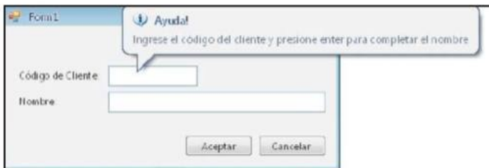
FIGURA 030 | ToolTip permite mostrar una ayuda al usuario cuando pasa el mouse sobre los controles.
