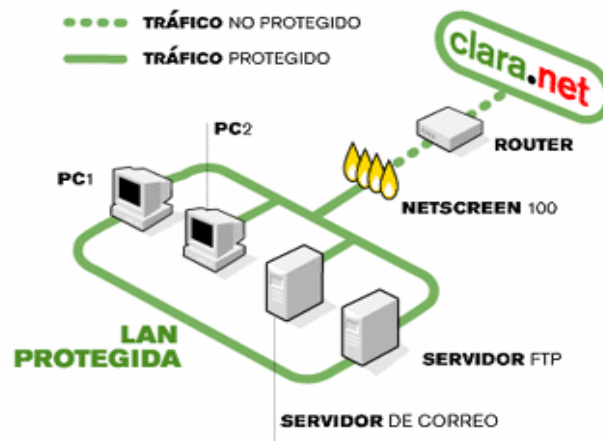
FIGURA 2.9: Implementación de un firewall, ilustrando tráfico protegido y no protegido.
