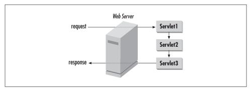
Figure 2-9. Servlet chaining
