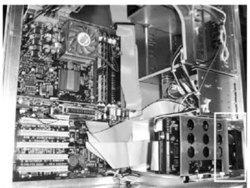
Figure 5-6: Proper fan placement
