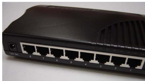
Fig. 2.5. Hub o Concentrador con 8 puertos
