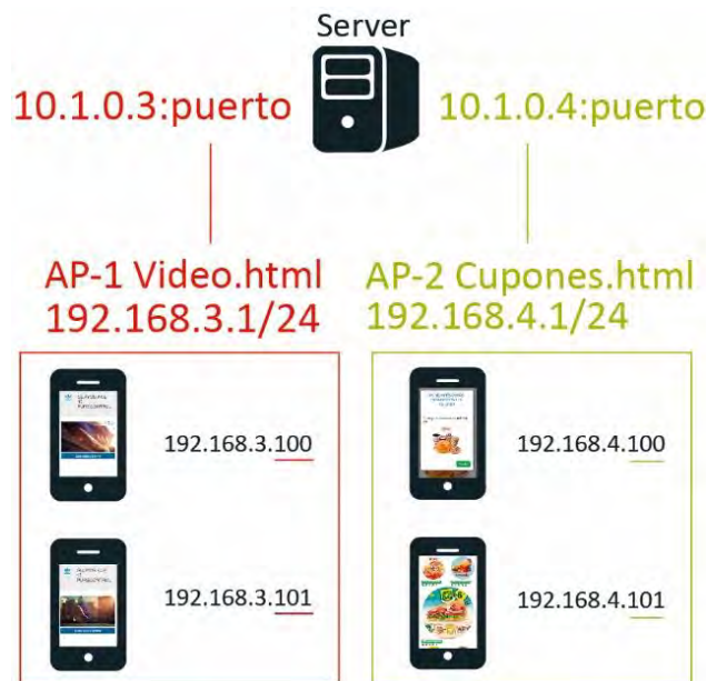
Figura 40. Resultados esperados de la prueba de implementación mediante “NAT”
