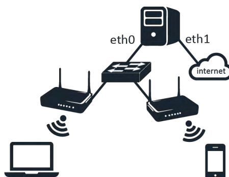
Figura 28. Topología de la red para las pruebas de implementación del portal cautivo
