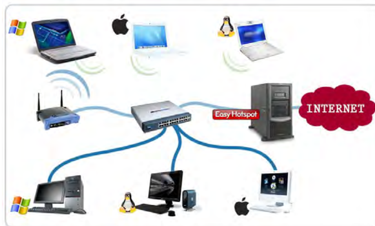
Figura 16. Arquitectura de red para la implementación de un portal cautivo usando “EasyHotSpot”
