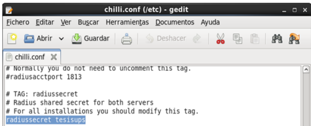
Figura 78. Configuración de la Sección radiussecret en chilli.conf
