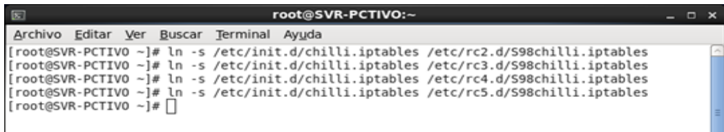
Figura 73. Creación de Enlaces Simbólicos Firewall de Chillispot
