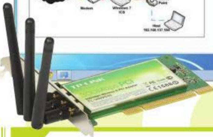
**1** Conectamos nuestra WAN que proviene del módem en la placa de red Ethernet, luego nos conectamos a la red inalámbrica, con DHCP deshabilitado. Ingresamos a Configuración del Adaptador, y presionamos el botón derecho del mouse en Conexión de área local/Usos Compartidos; aquí tildamos la primera opción, para compartir el recurso de red.
