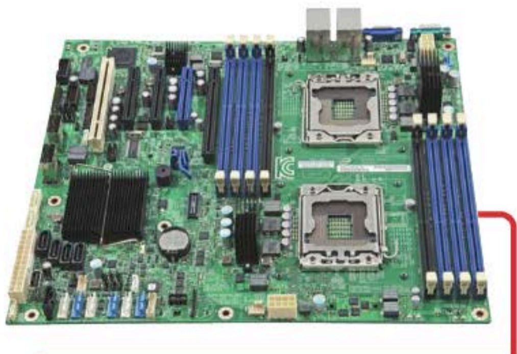
Intel Server Board S2400SC2. Soporta 2 procesadores Xeon E5, 8 módulos DDR3, 14 discos, 4 slots PCI Express y 1 slot PCI.
