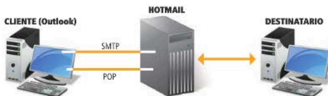
Aquí podemos observar cómo los protocolos SMTP y POP3 trabajan en conjunto, utilizando un servidor de correo.
