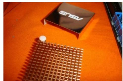
Como nos encontramos con un disipador conjunto tanto para Chipset como para Mosfets se nos hace imposible aprovechar el disipador por separado para los Mosfets (recordamos que aplicaremos un bloque nuevo al Chipset.)
