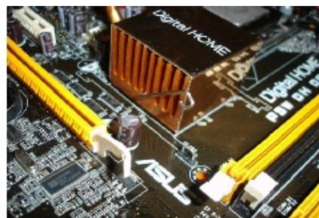
En mi caso el disipador del chipset va unido al disipador de los Mosfets por un heat-pipes, por lo que tendremos que quitar las sujeciones del disipador en los Mosfets.
