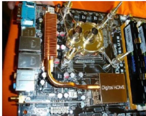
Finalmente atornillaremos la placa a la carcasa con el bloque de la CPU.
