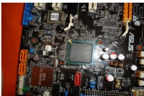
Como con el bloque del Chipset no se nos adjunta ninguna almohadilla protectora para el chipset he usado los protectores que adjuntaba un disipador de ATI para sus memorias.
