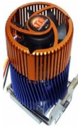
En la refrigeración pasiva tiende a suceder que el aire que rodea al disipador se calienta, y su capacidad de evacuar calor del disipador disminuye. Aunque por convección natural este aire caliente se mueve, es mucho más eficiente incorporar un mecanismo para forzar un flujo de aire fresco a través de las aletas del disipador, y es exactamente lo que se logra con la refrigeración activa.
